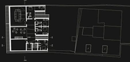
**DG1** Die Dachgeschosße haben mit der durch die Tiefe des Baukörpers bedingten Aufteilung des Daches mit einer komplexen Dachkonstruktion umzugehen. Um sie ebenso für den Hotelbetrieb nutzbar zu machen, werden in die höfseitigen, Richtung Süden gerichteten Dachschrägen Dachflächenfenster eingebaut. In den senkrecht zum Hauptgiebel stehenden Giebeln der rückwärtigen
